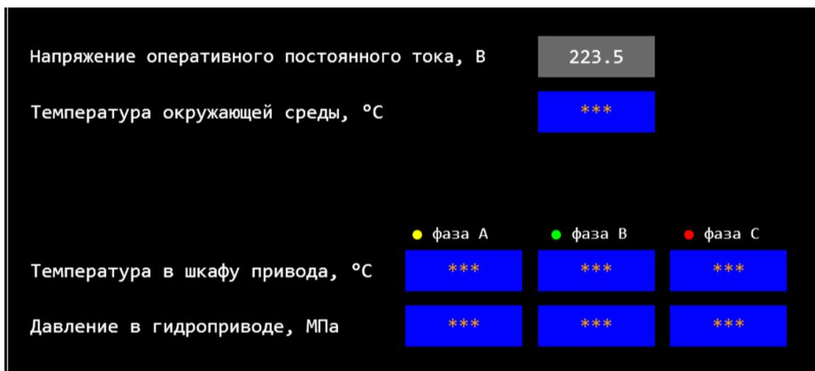
Рис. 3.38. Отображение параметров внешней среды
